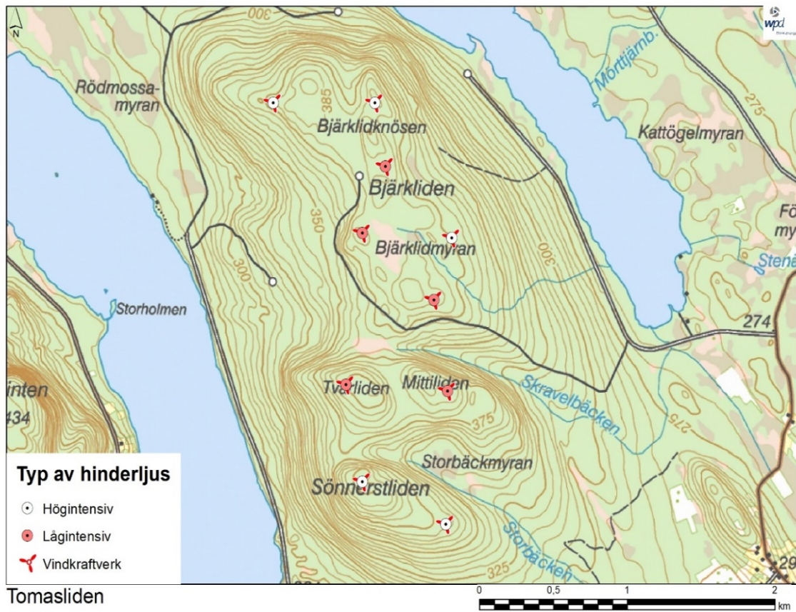
Figur 4-A. Exempel på placering av hinderljus.
