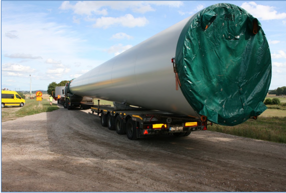
Transport av tornsektion.
