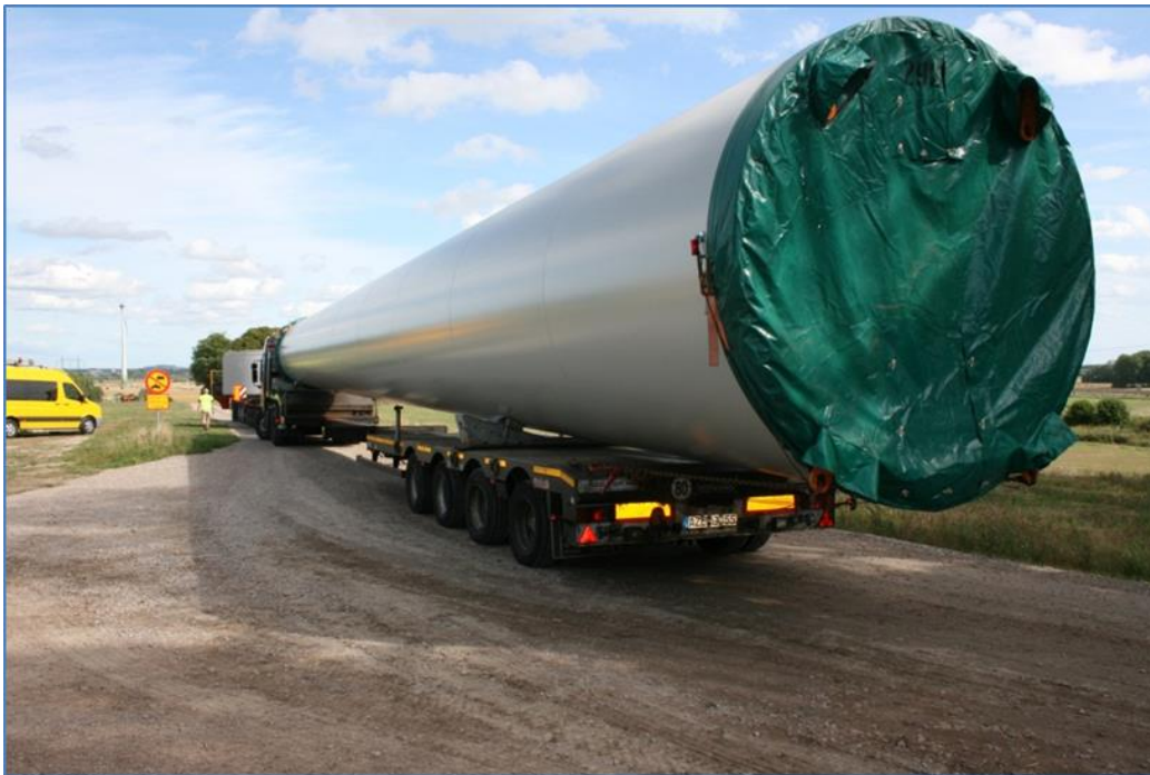
Transport av tornsektion.
