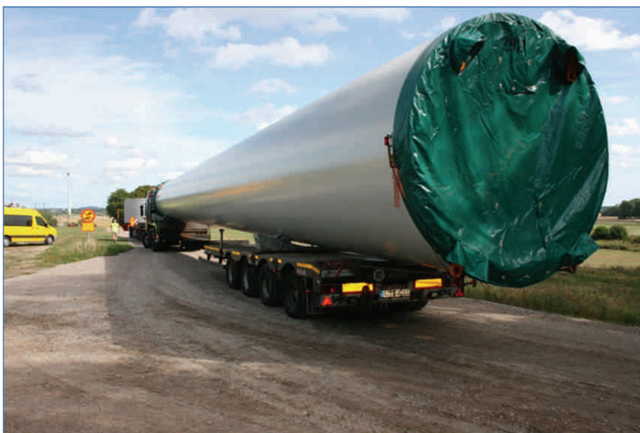
Transport av tornsektion.
