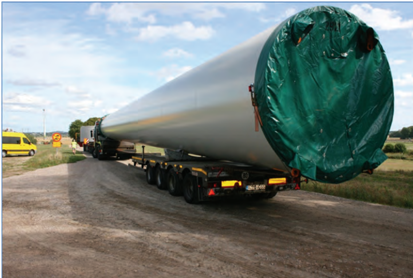
Transport av tornsektion.
