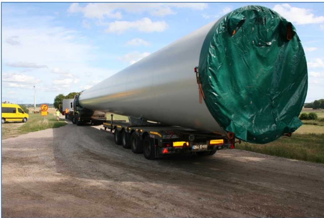
Transport av tornsektion.
